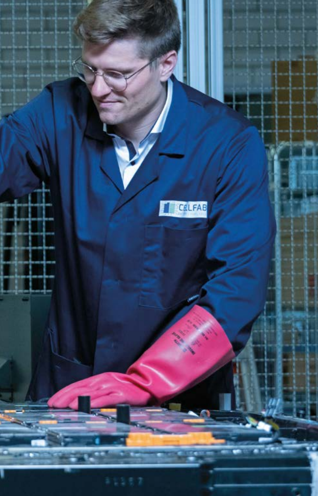
Natalia Soldan mit ihrem Kollegen Timon Elliger beim manuellen Zerlegen einer tiefentladenen E-Auto-Antriebsbatterie
