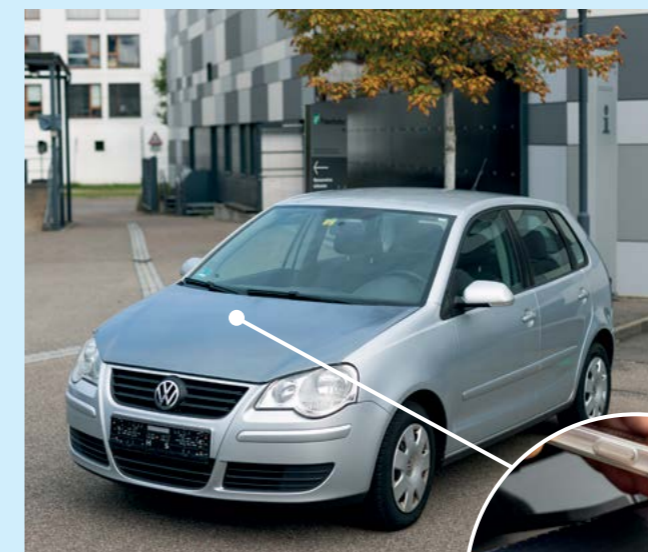
Farblich passend: Freiburger Forscher:innen brachten eine Folie mit Solarzellen auf der Motorhaube eines VW-Polos an.
